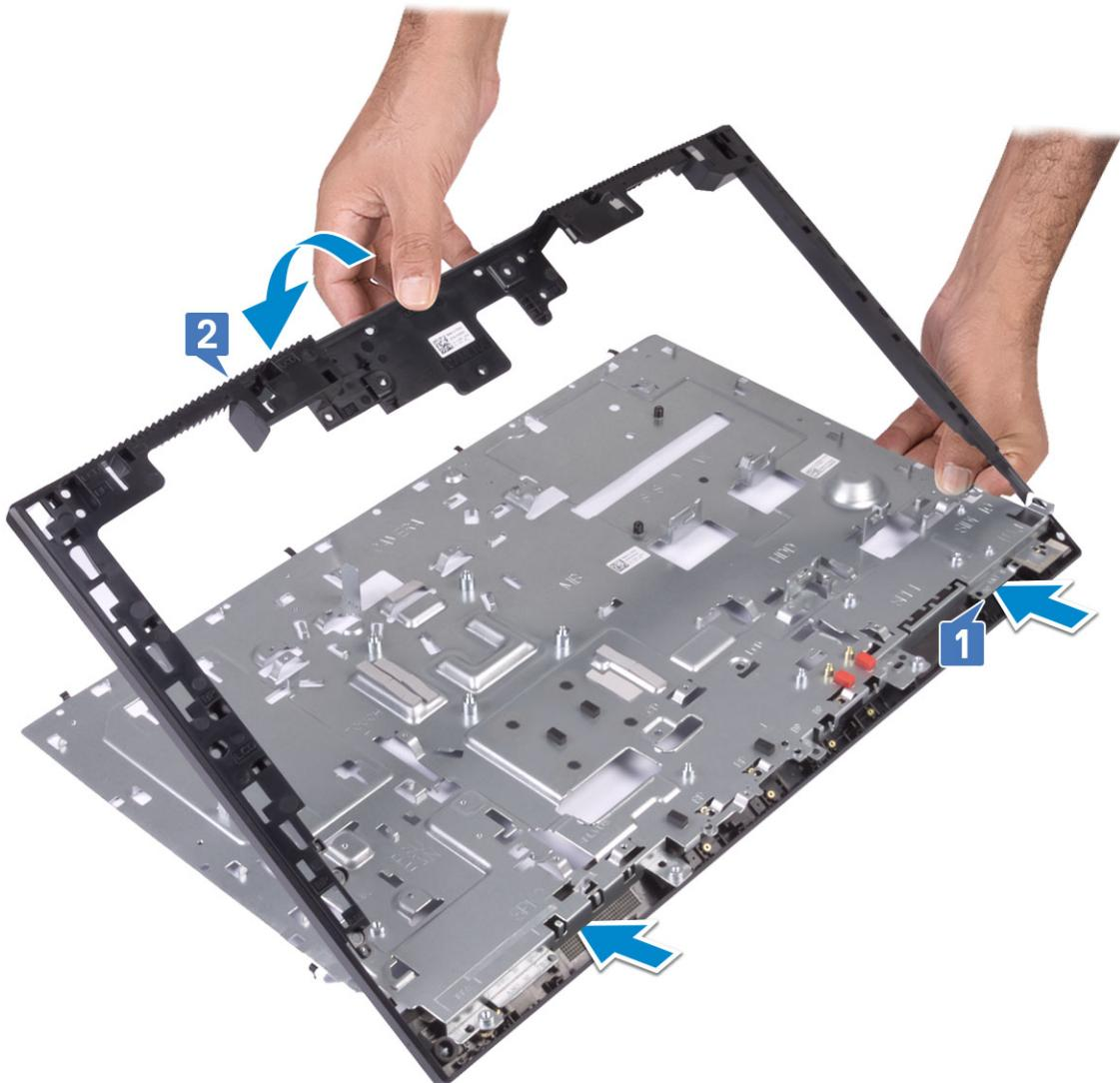
2 拧上将中框固定至显示屏部件底座的 15 颗螺钉 (M3x5) [2]。
